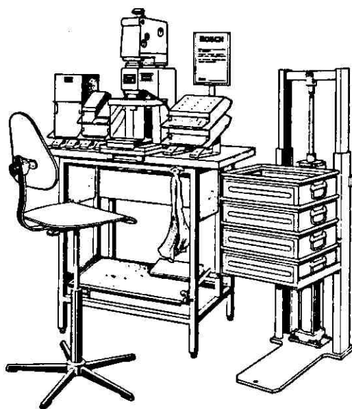
Slika 21: Opremljeno montažno mesto z zalogovniki in montažnimi napravami
